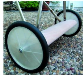
Das fertige Fahrwerk mit den Rädern, den schon bespannten Felgen und den Reifen aus Moosgummi
