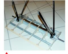
Das Fahrwerk, hier noch nicht beplankt. Es ist wie eine Rippenfläche aufgebaut und hat einen genieteten Hauptholm aus Aluminium. Die beiden daran angenieteten Traversen aus Stahlblech dienen zur Führung der Achse. Die Radachse ist an beiden Enden mit Gummiseil gefedert
